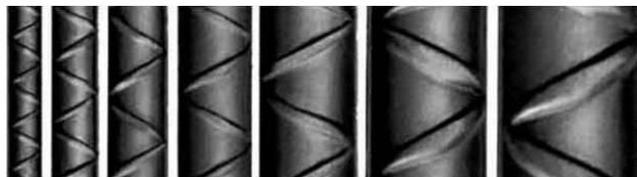
Son barras de acero de sección circular, resaltos en su superficie, obtenidas a partir de planquillas o lingotes laminados en caliente. Son utilizadas como refuerzo en las estructuras de concreto armado. Grado A42: fluencia mínima 4.200 kg/cm<sup>2</sup>. Resistencia a la tracción 6.300 kg/cm<sup>2</sup>.
