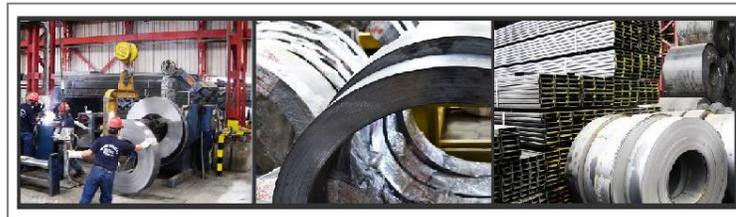
Son productos de acero laminados en frío o caliente, para la fabricación de vigas electro soldadas, cortados de bobinas laminadas que se sueldan mediante el proceso de resistencia eléctrica de alta frecuencia. Son utilizados fundamentalmente en las industrias de la construcción metalmeccánica, industria petrolera y petroquímica.
