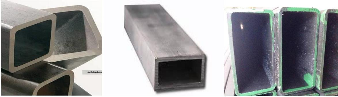
Constituye una línea nueva de productos de la compañía (tubería estructural). Son productos de acero obtenidos a partir de flejes, cortados de bobinas laminadas en caliente, cuyo ancho corresponde al diámetro del tubo a fabricarse. Dichos flejes son doblados dándole la forma tubular deseada (redonda, cuadrada o rectangular), se sueldan longitudinalmente y se cortan a la longitud requerida.
